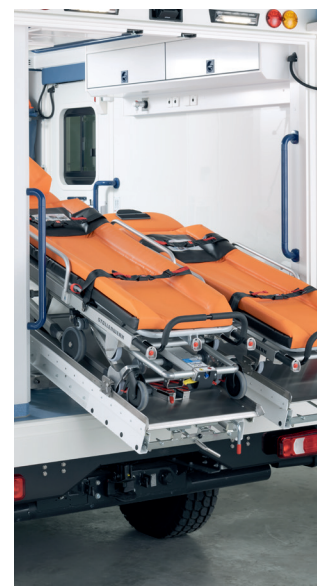
Hebeunterstützungen zur ergonomischen Entnahme der zweiten Trage und der Sauerstoffflaschen.
