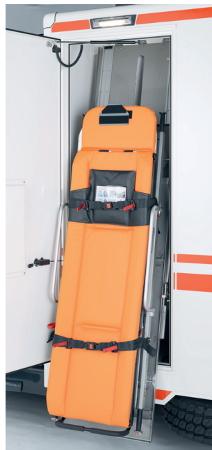
Hebeunterstützungen zur ergonomischen Entnahme der zweiten Trage und der Sauerstoffflaschen.
