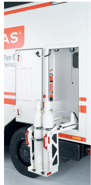
Hebeunterstützungen zur ergonomischen Entnahme der zweiten Trage und der Sauerstoffflaschen.
