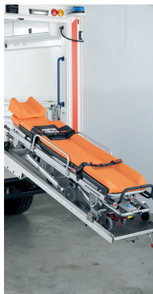
Hebeunterstützungen zur ergonomischen Entnahme der zweiten Trage und der Sauerstoffflaschen.
