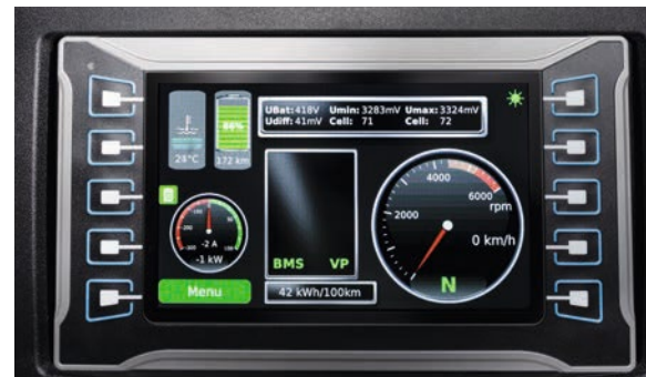
Die Cockpit-Anzeige liefert Informationen über das Fahrzeug-Management inklusive Restreichweite.
